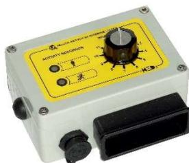
VR272RM ist auch mit dem 12-stelligen Wahlschalter ausgestattet, aber zusätzlich mit einem Taster an der linken Seite, für die Dokumentierung von aufgetretenen Ereignissen.
