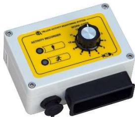
VR272R ist wie das Basisgerät VR272, ist aber mit einem 12-stelligen Wahlschalter ausgestattet, um verschieden auftretende Zustände zeitlich festzuhalten.
